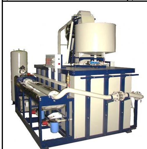
УПСЖ-ПРО 75 . Модификация с наибольшим воспроизводимым расходом 75 м 3 /ч
