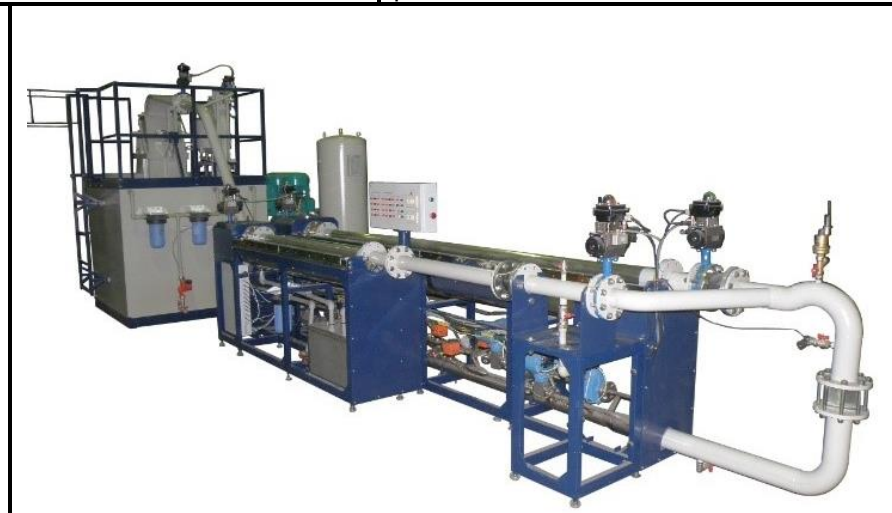
УПСЖ-ПРО 100. Модификация с наибольшим воспроизводимым расходом 100 м 3 /ч {опции: дополнительный объемный и массовый измерительные столы}
