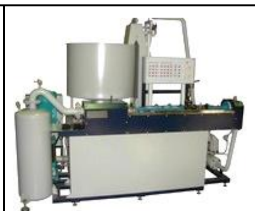
УПСЖ-ПРО 50. Модификация с наибольшим воспроизводимым расходом 50 м 3 /ч
