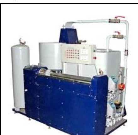
УПСЖ-ПРО 30. Модификация с наибольшим воспроизводимым расходом 30 м 3 /ч
