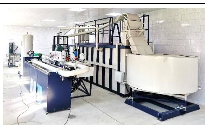
УПСЖ-ПРО 300 . Модификация с наибольшим воспроизводимым расходом 300 м 3 /ч
