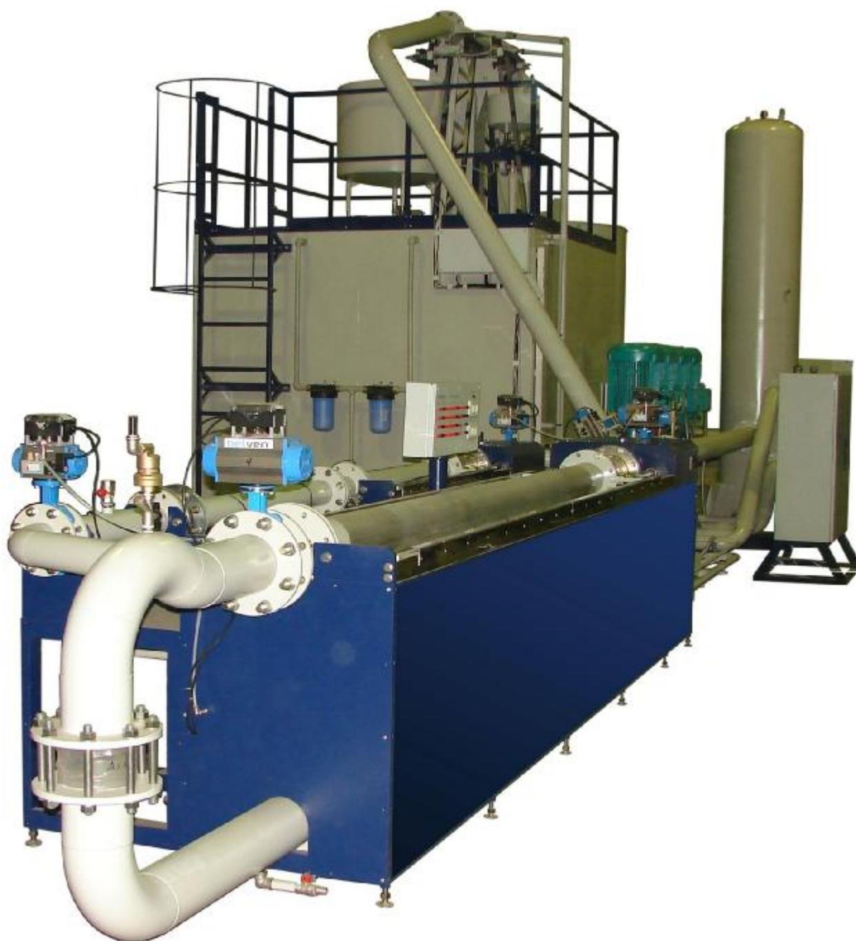
Рисунок 2 – Общий вид установок поверочных УПСЖ-ПРО
