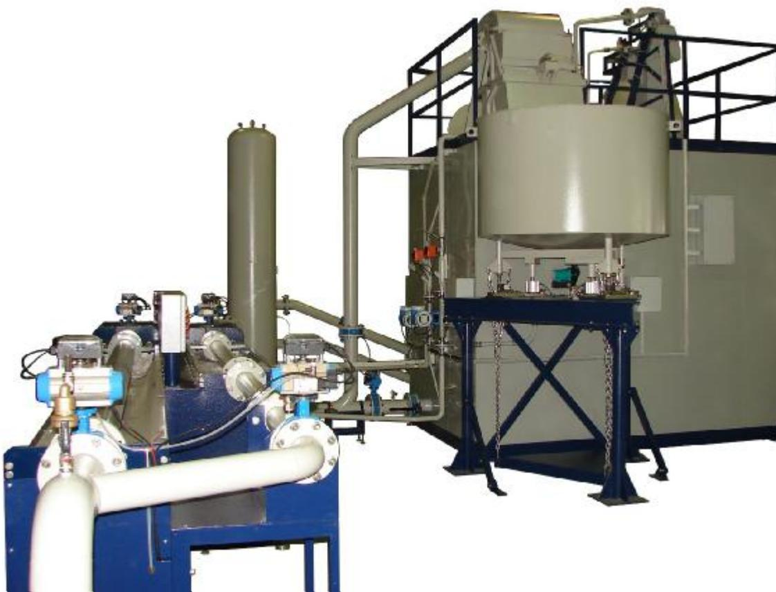
Рисунок 1 – Общий вид установок поверочных УПСЖ-ПРО
